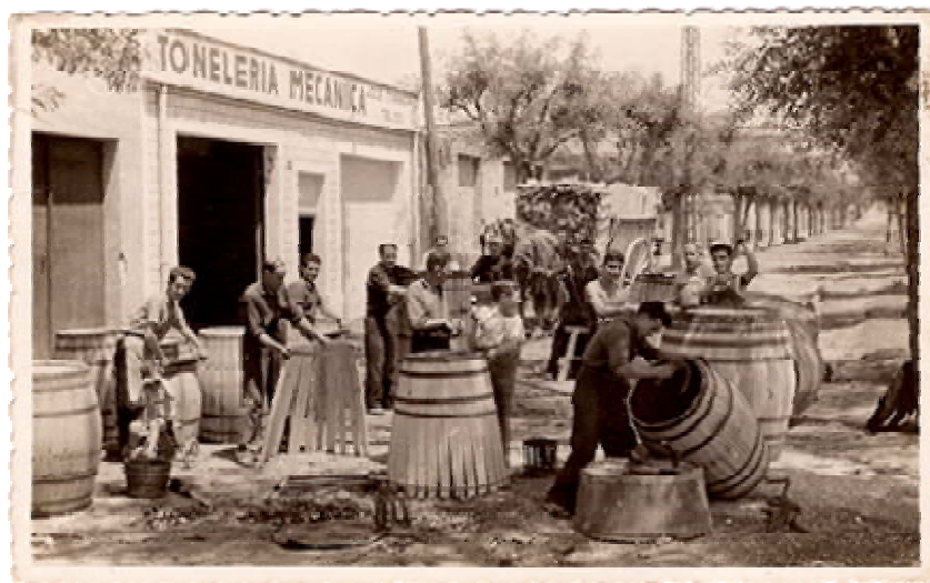
Figura 4. Construcció de bótes de castanyer. Anys 50, Vilafanca del Penedès.
