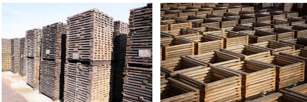
Figura 11. Dogues apilades al parc d'assecatge. Diferent disposició de les dogues per afavorir-ne l'airejament.
