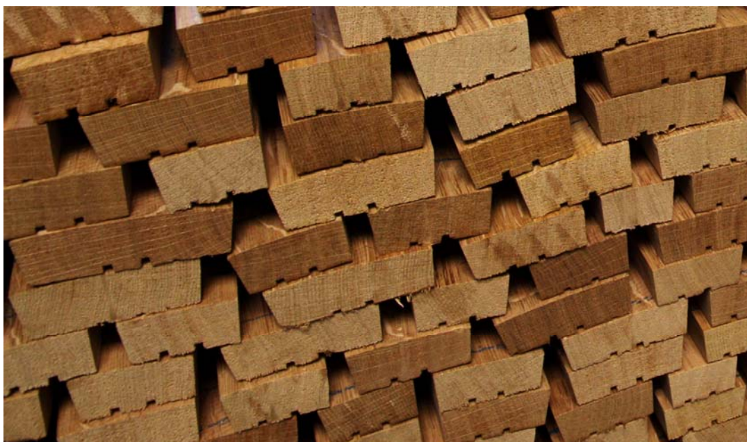
Figura 13. Dogues de roure europeu amb ranures realitzades en la cara interna.
