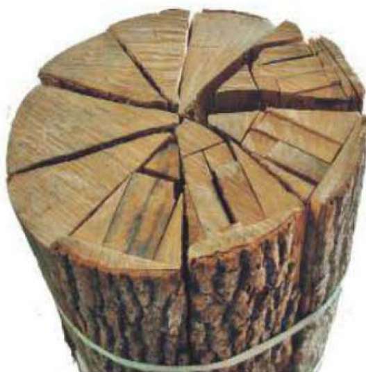
Figura 4. Tronc de Quercus petraea de grans dimensions (diàmetre de 60 cm aproximadament) on es mostra l'especejament per extracció de les dogues. S'aprecien els 8 quarterons i, dins d'aquests, la disposició de les dogues serrades. Font de la imatge: revista Slowfood, nº 52.
