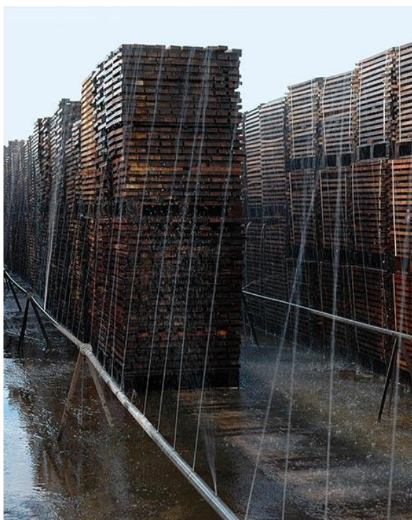
Figura 7. Reg per aspersió en un parc de fusta durant la fase d'assecat i maduració.
