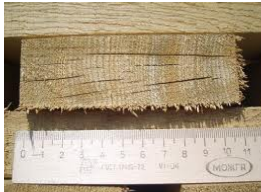
Figura 5. Testa d'una doga a l'inici del període d'assecatge. Presenta una amplada entre 10 i 11 cm (tot i que pot ser menor, de fins a 6-7 cm) i un gruix d'uns 3,3 cm.
