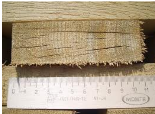
Figura 9. Testa d'una doga a l'inici del període d'assecatge. Presenta una amplada entre 10 i 11 cm (tot i que pot ser menor, de fins a 6-7 cm) i un gruix d'uns 3,3 cm.
