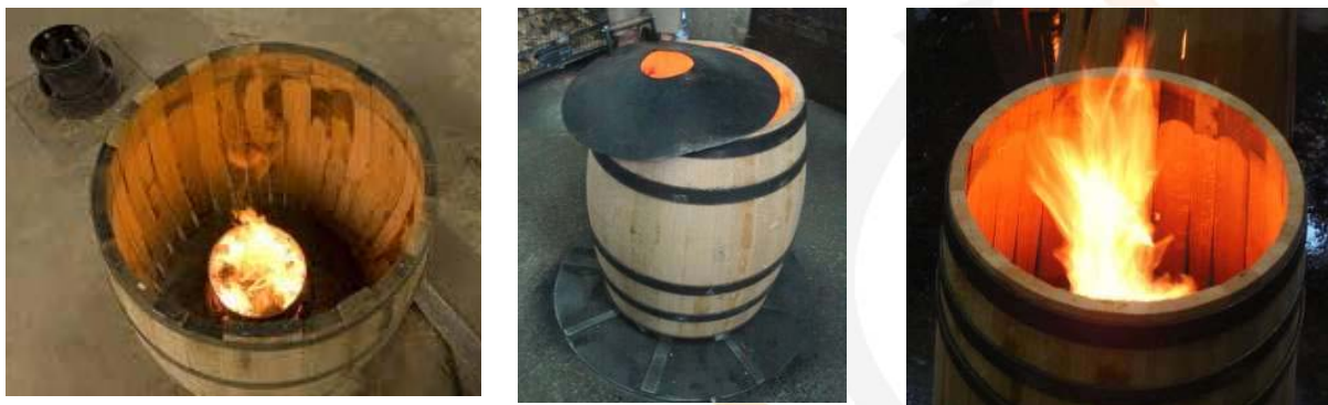
Figura 13. Imatges del procés de torrat. A l'esquerra, bóta amb el forn de torrat. Al mig, torrat amb tapa o "bordelès, a la dreta, " torrat amb bóta oberta o "de la Borgonya".
