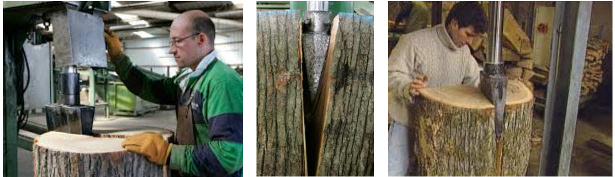
Figura 7. Fendatge dels trams de troncs de roures europeus de grans dimensions, per obtenir els quarterons d'on se serraran es dogues.
